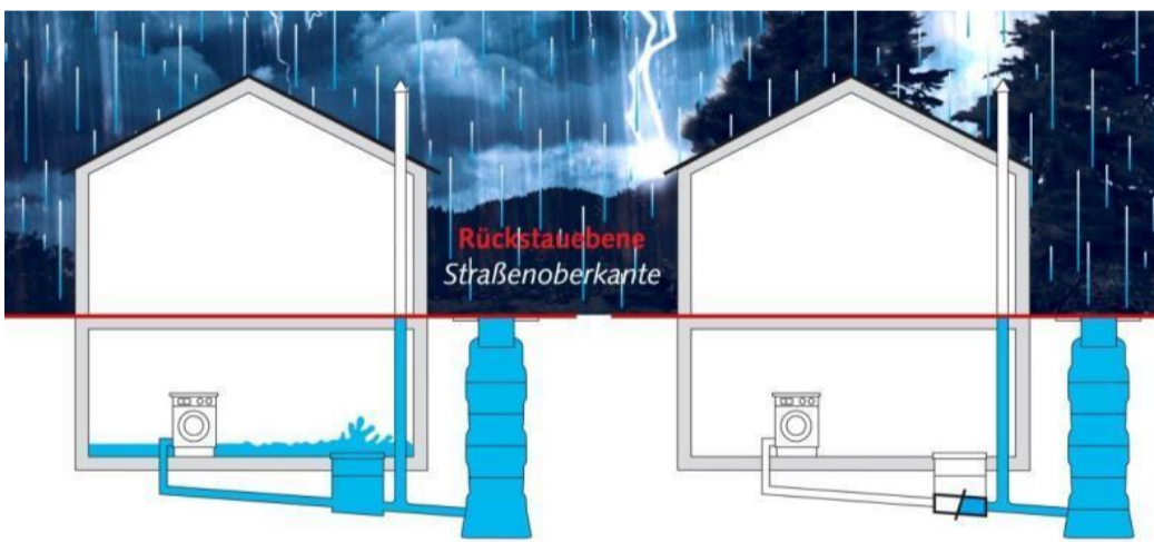
Problem: Entwässerungssystem ohne Rückstausicherung
